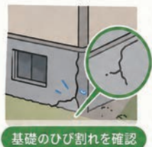
基礎のひび割れを確認
