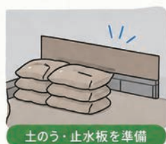
土のう・止水板を準備
